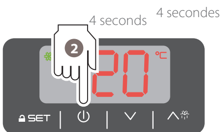
marche/arrêt du panneau activation/deactivation of the control panel
