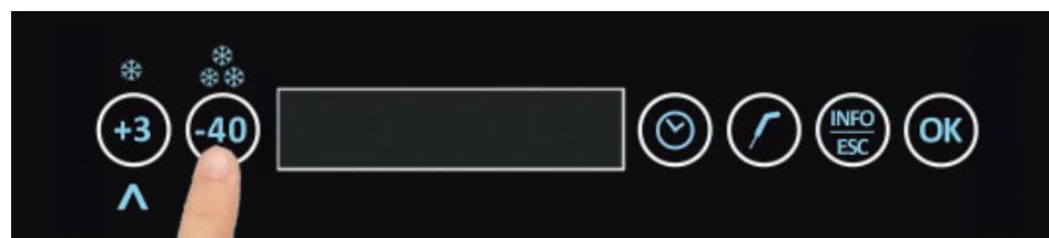
Wählen Sie anschließend mit den Tasten +3 / \* oder -40 / \*\*\* das Untermenü 5 aus
