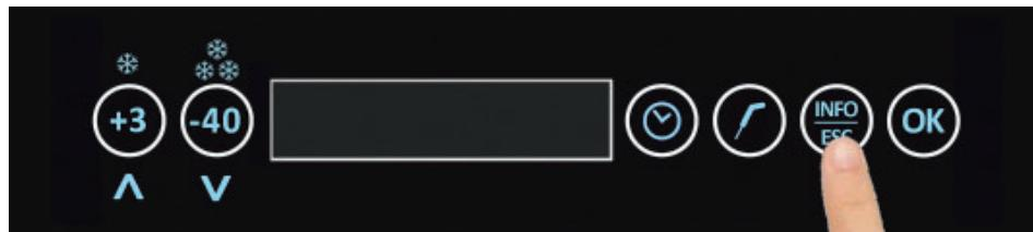
Wird am Display READY angezeigt, drücken Sie die Taste Info-ESC.
