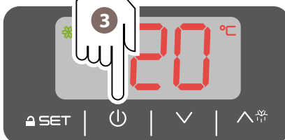
4 секунды 4 secondi включение/выключение панели activation/deactivation of the control panel
