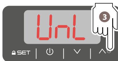
разблокировка кнопочной панели unlocking the keypad
