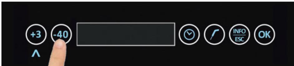
Wählen Sie anschließend mit den Tasten +3 oder -40 das Untermenü 1 aus
