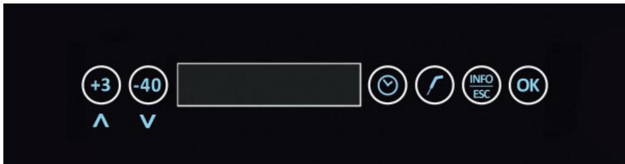
Die Modelle sind mit der Leistungsplatine „Compact“ und dem kapazitiven Display „Glass“ ausgestattet. Die Benutzeroberfläche ist mit einem 6-stelligen LED-Display, Scroll-Anzeige und den folgenden 6 kapazitiven Tasten versehen:
