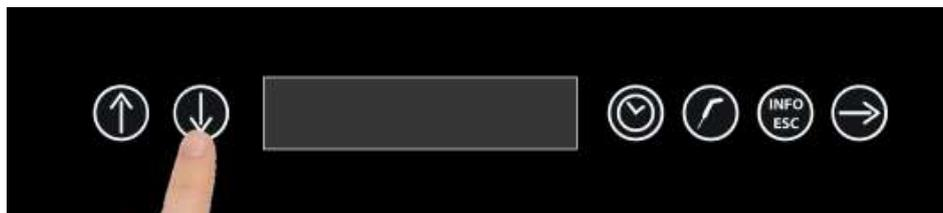
Avec les touches flèches HAUT et BAS sélectionner le cycle **-20°C**.
