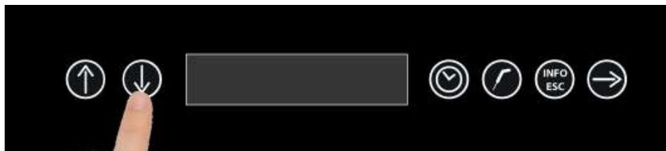
Avec les touches flèches HAUT et BAS sélectionner le cycle **DÉGIVRAGE**.
