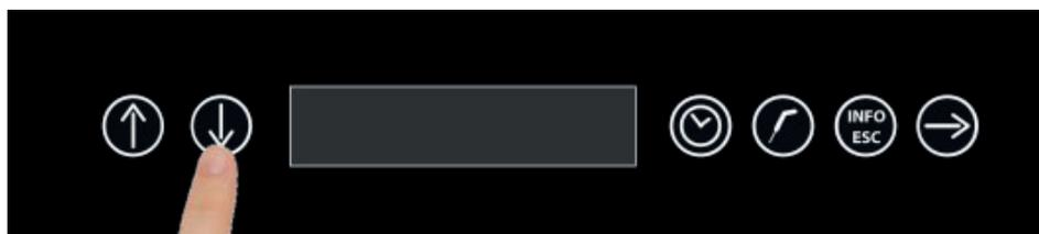
Depuis l'appareil en mode STOP, avec les touches flèches HAUT et BAS, sélectionner le cycle 5 DÉCONGÉLATION MANUELLE.
