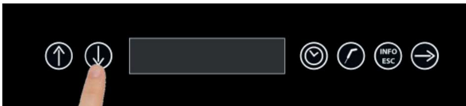
Avec les touches flèches HAUT et BAS sélectionner le cycle 6 DÉGIVRAGE.
