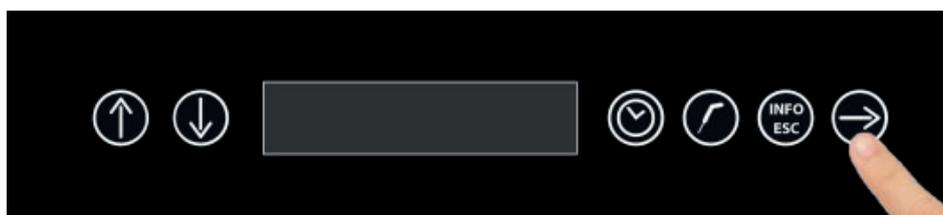
La pression de la touche CONFIRMER permet de programmer le paramètre de température au produit du cycle
