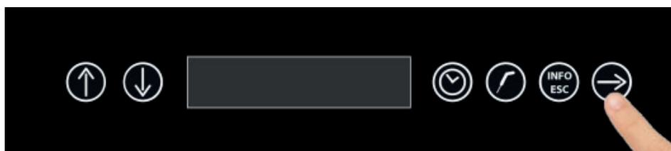
La pression de la touche CONFIRMER permet de programmer le paramètre de température au produit
