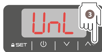
clavier déverrouillé unlocking the keypad
