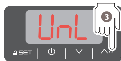
desbloqueo teclado unlocking the keypad
